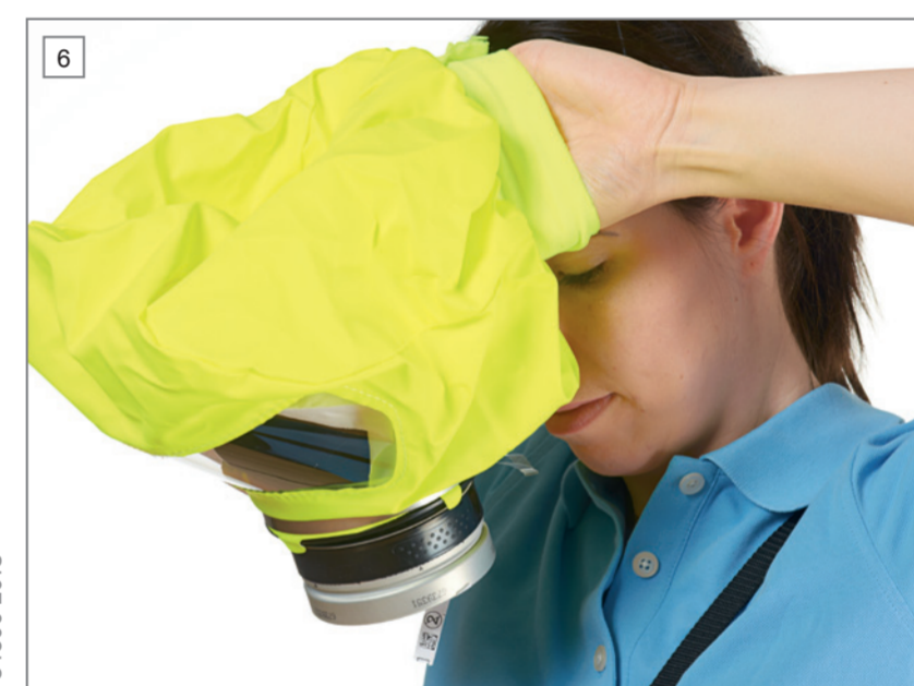
Weiten Sie die Halskrause und stülpen Sie die Haube über Ihren Kopf. Die Kopfbänderung passt sich automatisch an. Versichern Sie sich, dass Nase und Kinn in der Halbmaske sitzen und alle Haare unter der Haube sind.
