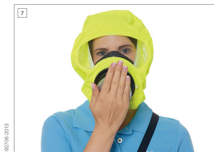
Prüfen Sie den Dichtsitz, indem Sie die Filteröffnung mit dem Handball verschließen und einatmen. Ist ein Luftzug spürbar, korrigieren Sie den Sitz der Haube.
